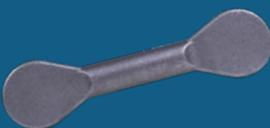
Erste Stufe der Umformung des Teils im Gesenk geschmiedet, mit einem Gewicht von 50 gr. bis 5 Kg.
